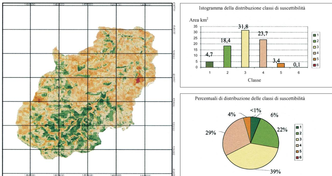
Fig. 3. Carta della suscettibilità all'erosione dei suoli del bacino montano del Rio S. Lucia con la distribuzione areale e percentuale delle classi di suscettibilità utilizzate.
